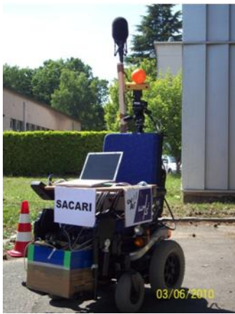
Figure 5. Véhicule robotisé utilisé dans l'expérience de télé-immersion.
