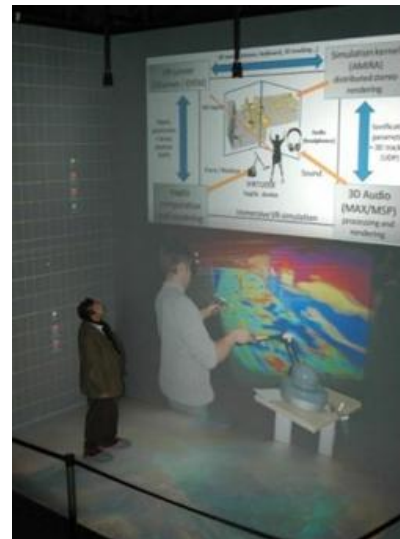
Figure 1. Le système EVE dans sa configuration « immersion complète ». L'immersion est assurée à la fois par la dalle rétro projetée, et à la hauteur des écrans verticaux.
